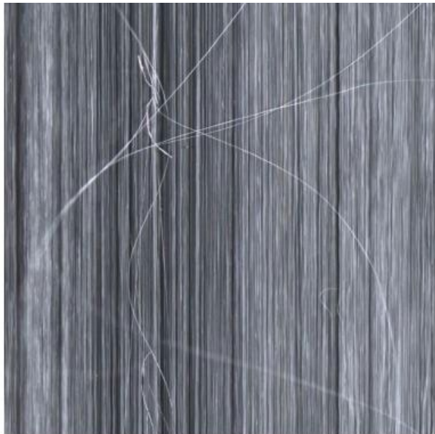
© Fraunhofer IGCV Aufnahme eines Faserbündels auf Carbonfaserteppich. Links: Originalaufnahme Rechts: Segmentierter Defekt
